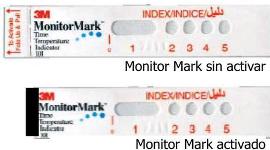
Si la temperatura supera los 10 °C, un color azul irregular se desplaza a lo largo de la escala de la etiqueta por las ventanas numeradas de la 1 a la 5, indicando el tiempo aproximado en horas (variable según la temperatura alcanzada sea próxima o muy superior a 10 °C) en que se ha superado esa temperatura.
